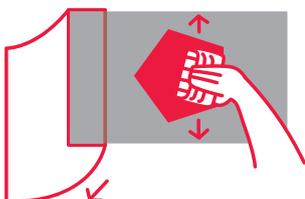
Répétez le mouvement de la raclette (du centre vers les extrémités) par petites passes tout en retirant progressivement le liner. Le mouvement doit être ferme pour chasser les bulles d'air et les plis. Faites se chevaucher les coups de raclette.
