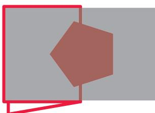
Séparez le liner du reste du sticker en veillant à ce que le vinyle reste sur le tape. Effectuez une coupe du liner si nécessaire et le replier vers l'arrière sur quelques centimètres afin de faire "**charnière**".
